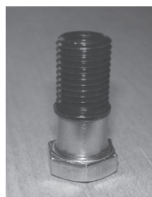
Bøsning med bolt og rørstykke + Lock-tide.
