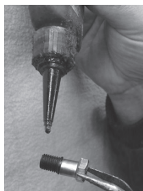
Bøsning med bolt og rørstykke + Lock-tide.
