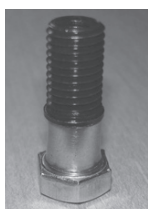
Bolt med møtrik el. rørstykke til i-sætning af bøsning.
