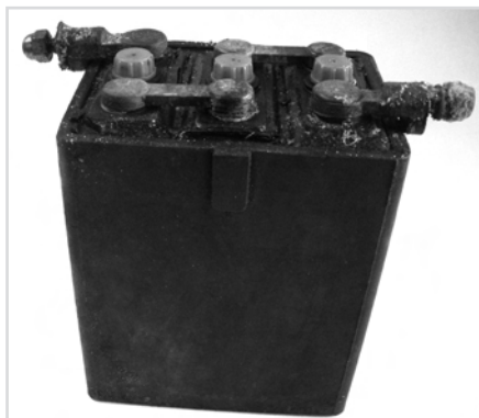
Det gamle Nimbusbatteri kan ikke mere. Bemærk "kagerne" af ir på pluspolen.
