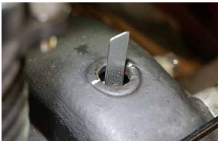
Den lille ”dime” i hullet ud for den påførte steg på blokken.
