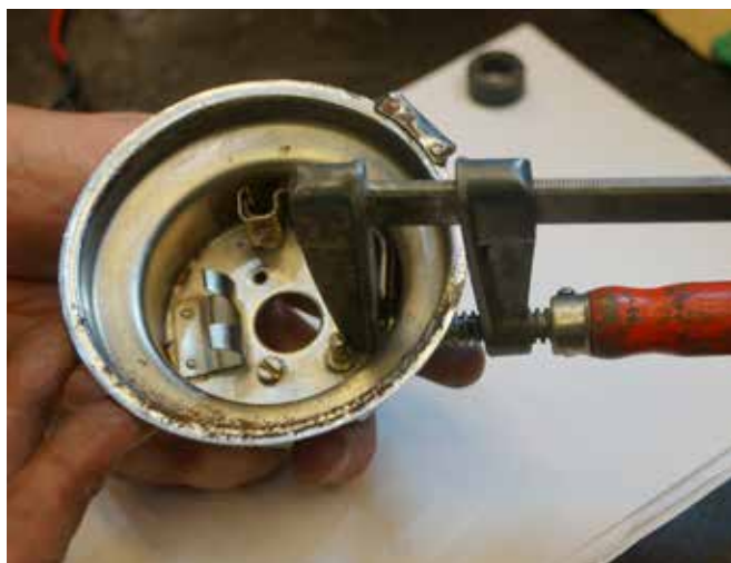
Vi måtte presse/klemme bøjlen lidt ind med en lille skruetvinge.
