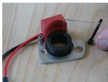
Krympeplast-stykket trækkes over bøjlen og hanstikket
